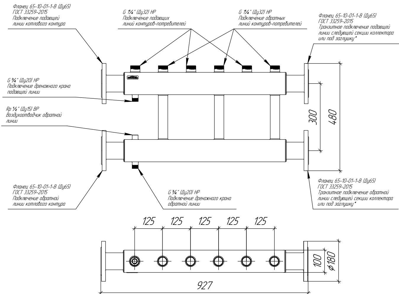
\*Пристыковке с другим коллектором для фланцевых соединений необходимо использовать сильфонный компенсатор.
